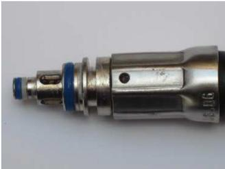
Der Wechsel dieser O-Ringe an den Schlauchkupplungen wird in den Wartungsanleitungen beschrieben und in unseren Gerätewart-Lehrgängen geschult. Ebenfalls wird auf notwendige Werkzeuge zum Wechsel der O-Ringe hingewiesen.
